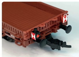
Je eine klassische Zugschlusslaterne und Zugschlussstafel sind vormontiert. A classic train rear lantern and a tail end indicator are mounted.
